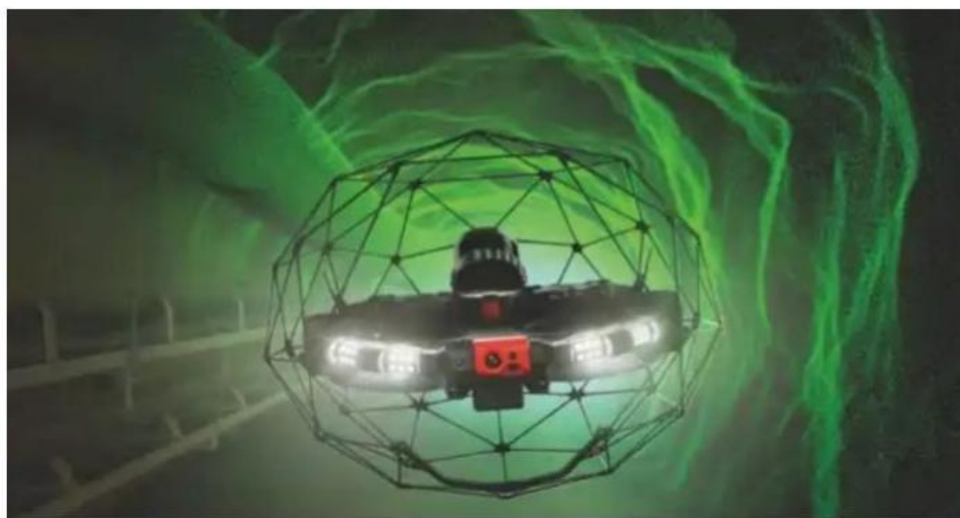
图 1 密闭空间无人机测量实物图
